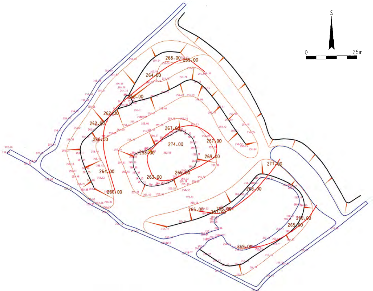
Obr. 180: Mrdce, okres Chrudim. Srovnání zaměření torziště totální geodetickou stanicí a přístrojem GPS. černé linie – obvod vnitřního prostoru a průběh korun valů podle zaměření totální geodetickou stanicí; fialová čísla – polohy a absolutní výšky bodů zaměřených totální stanicí; červené linie – obvod vnitřního prostoru a průběh korun valů podle zaměření přístrojem GPS; tmavohnědá barva – polohy a absolutní výšky bodů zaměřených přístrojem GPS; světlehnědá hnědá barva – spádnice a dna příkopů a depresí; modré linie – obvod vodních ploch podle zaměření totální geodetickou stanicí. Zaměření P. Vitula 2007.
