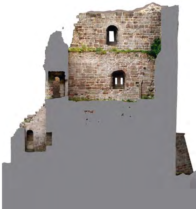
Obr. 216: Přimda, okres Tachov. Řez texturovaným modelem hradního donjonu vytvořeného na základě dat laserového skenování. Podle SOKOL 2015b.
