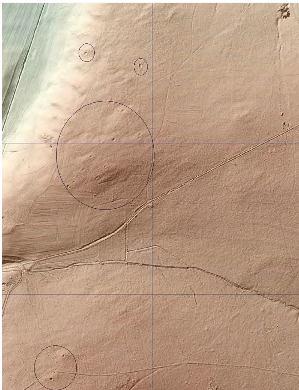
Obr. 232: Bezemín, okres Tachov. Projevy povrchové těžby (prospekce) na vizualizaci dat LLS. Prospekční jámy se táhnou o severo-j jižním pásu podél západního okraje vyvýšené plošiny. Rastr mapy 500 m. Data ČÚZK Praha, zpracoval O. Malina a P. Sokol 2015.
